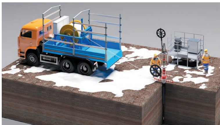
Схема расстановки спускоподъемного оборудования комплекса Stream Tracer™
